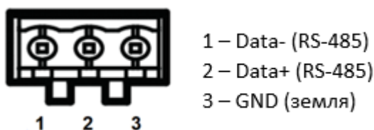
Рисунок 7.4 – расположение и назначение контактов клеммного соединителя второго порта RS-485
