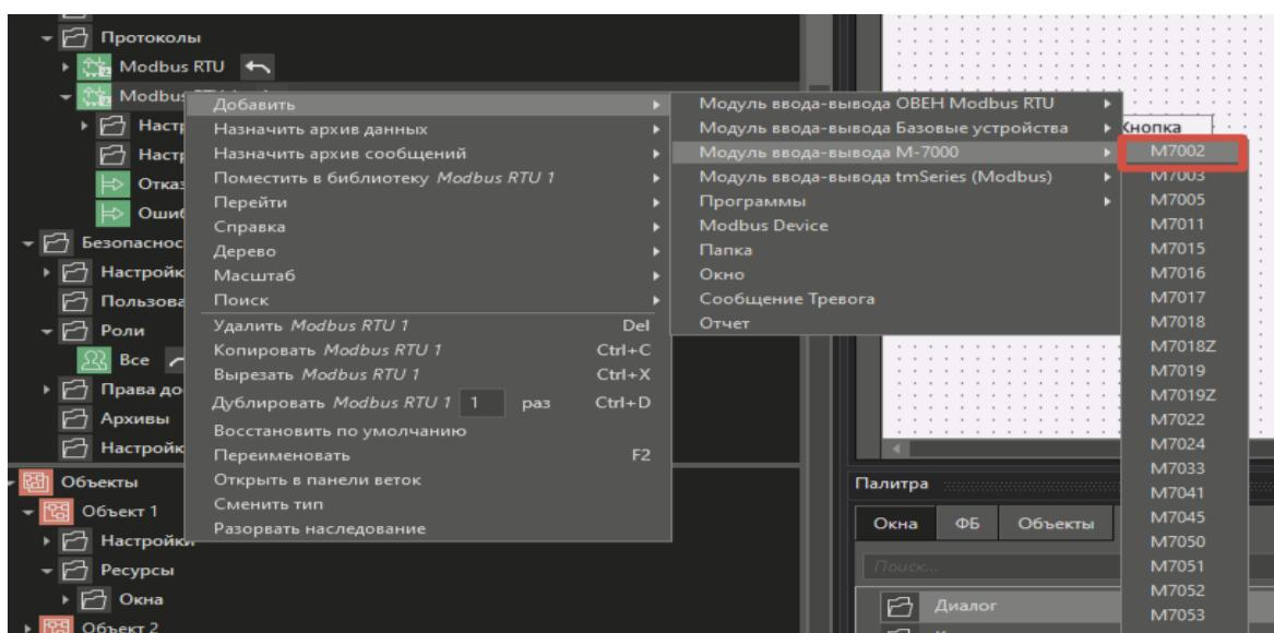
Выделим добавленный модуль в дереве системы и в панели свойств зададим адрес модуля. В нашем случае адрес будет равен 10. Это адрес модулей данной серии по умолчанию. Для изменения адреса модуля и параметров обмена используется фирменная утилита компании ICP DAS.
