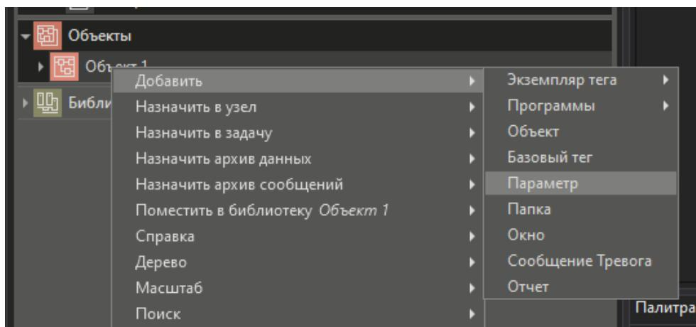
На экране появится диалог настроек добавляемого параметра. Здесь задать его имя и тип. Оставим их заданными по умолчанию: имя – **Параметр 1**, тип - **LREAL**.
