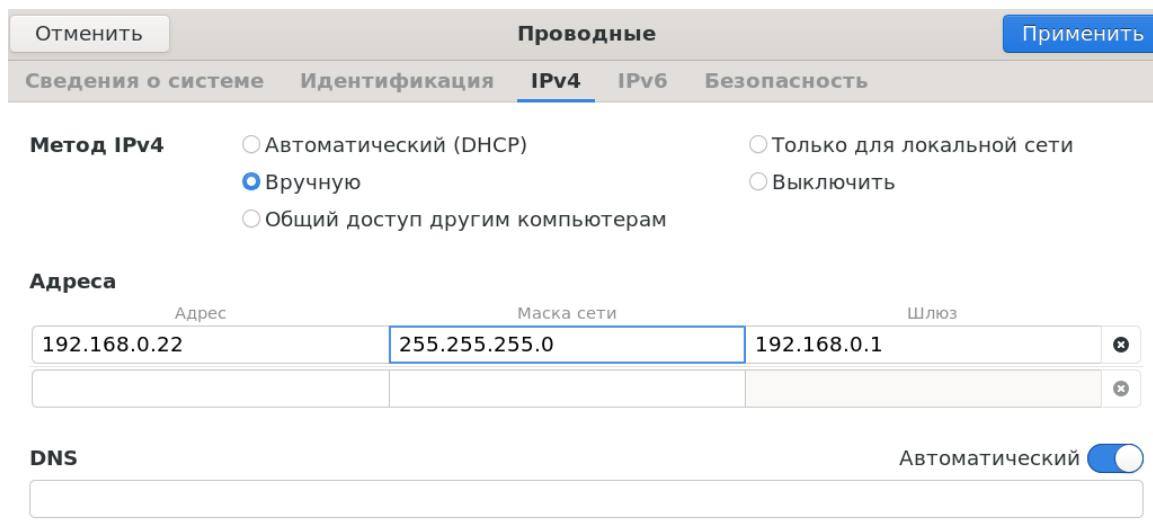
Для установки статичного IP-адреса в открывшемся окне настроек сети следует выбрать вкладку **IPv4**, установить радиокнопку **Вручную** и в появившихся ниже полях ввести нужный IP-адрес, маску сети и шлюз, после чего нажать кнопку **Применить** в верхнем правом углу;
