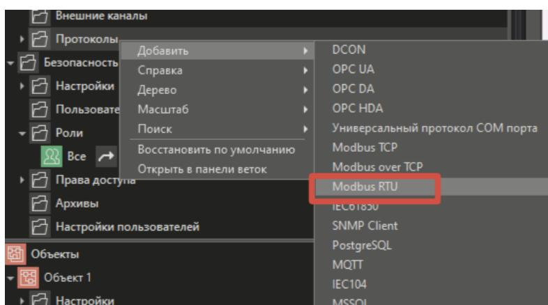
Далее следует настроить добавленный протокол. Для этого выделим его в дереве системы и в панели свойств введем необходимые настройки.
