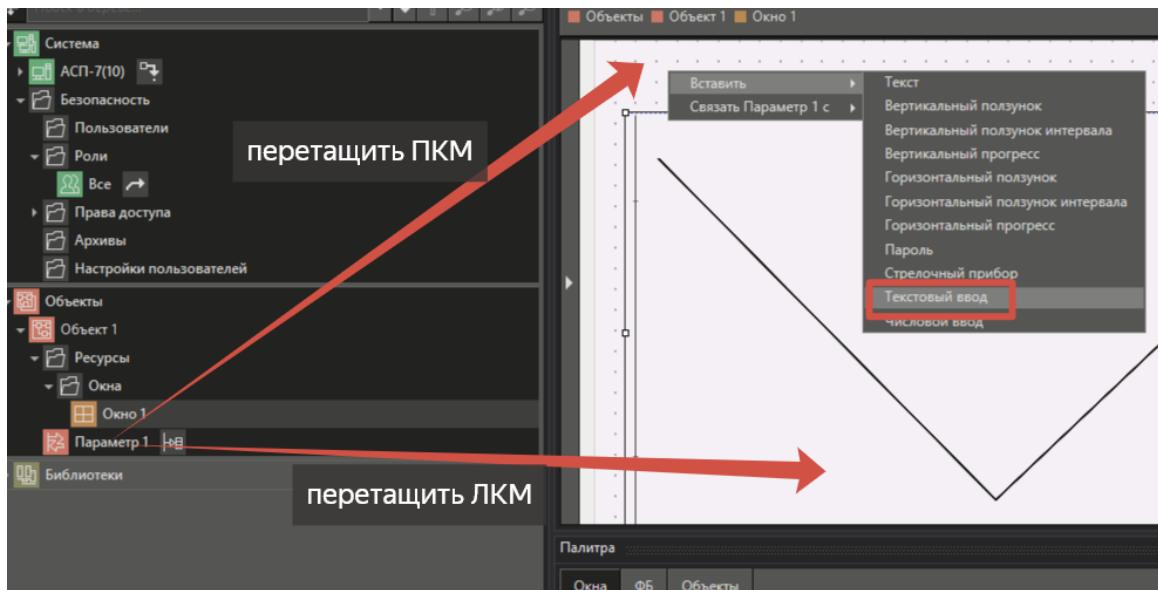
Чтобы размещенный на экране тренд отображал значения параметра **Параметр1** надо перетащить, нажав и удерживая ЛКМ, данный параметр из дерева объектов на элемент **тренд**, связав тем самым элементы **тренд** и **параметр** друг с другом.
