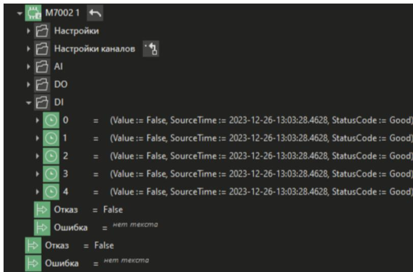
При замыкании контактов модуля можно наблюдать в среде разработки MasterSCADA 4D изменение состояния входов M-7002-G. В данном примере вход «DI.COM» M-7002 связан с GND питания, а на вход «DI4» подается +24 В. Подробнее см. Руководство на модуль ввода-вывода M-7002
